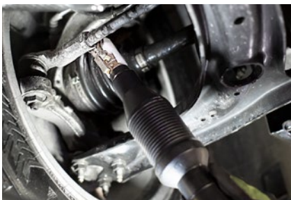
EINSATZ BEI DER ACHSVERMESSUNG SICHERES LÖSEN VON SPURSTANGEN
