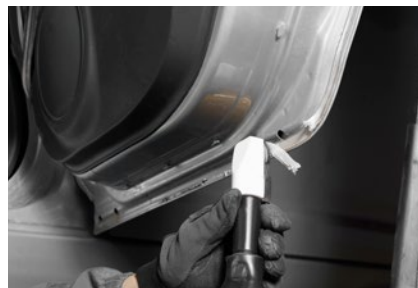
EINSATZ BEI UNFALLREPARATUR SCHONENDES LÖSEN DER TÜRDICHTUNG
