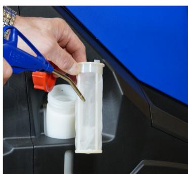
3. Reinigen Sie den Filtereinsatz mit Druckluft.
