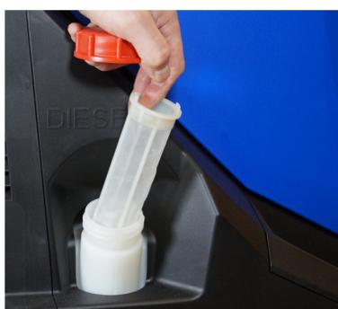
2. Ziehen Sie den Filtereinsatz aus dem Tankstutzen.
