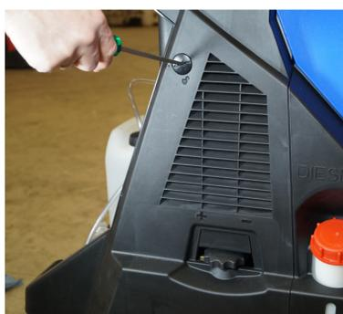
1. Öffnen Sie die seitliche Verkleidung durch drehen der Schnellverschlüsse.
