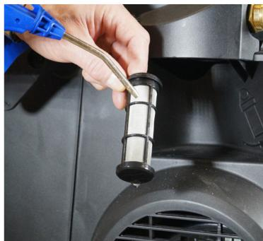
3. Reinigen Sie den Filtereinsatz mit Hilfe von Druckluft oder sauberem Wasser.
