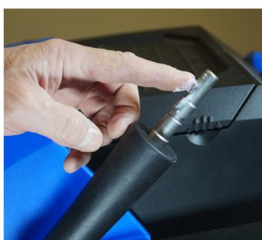
1. Fetten Sie den Nippel am Strahlrohr.
