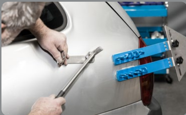
Die CBR PushPull-Druckluftpresse ergänzt das CBR-System ideal.
