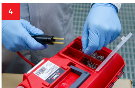
Geeignete Klammer für die zu reparierende Beschädigung auswählen.
