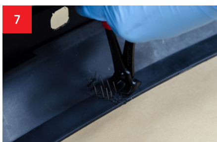
Die herausragenden Klammerdrähte werden mithilfe des Schneiders gekürzt.
